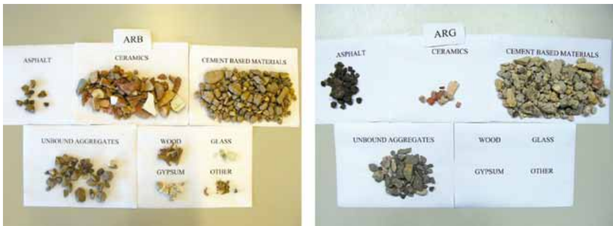
1. irudia. Agregakin birziklatuen osagaiak (ARB eta ARG serieak).
