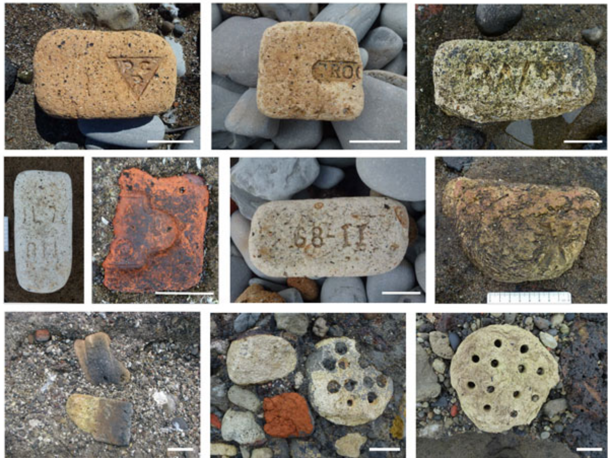
Fig. 5. Ladrillos refractarios fragmentarios con restos de siglas, acrónimos y números en las playas cementadas de Tunelboka y Gorrondatxe (Getxo, Bizkaia). Los dos primeros (arriba, izquierda y centro) provienen de los depósitos de Gorrondatxe y pudieron ser fabricados en la ya mencionada empresa Sociedad General de Productos Cerámicos S.A. (PROCERSA) (Fig. 3). El ladrillo de la fotografía superior derecha es de Tunelboka y lleva la inscripción W 2. La letra W puede corresponder a la abreviatura inglesa de weight, peso. Abajo a la izquierda pueden observarse, incluidos en la roca industrial de Tunelboka, dos fragmentos de ladrillos refractarios con claras señales de desgaste y alteración por los materiales fundidos del interior del horno en el que un día estuvieron. Abajo en el centro y derecha se muestran dos ladrillos fragmentarios de gran tamaño que, por su forma cilíndrica y perforaciones, pudieron colocarse en los regeneradores de calor o en la zona de toberas (?) de los hornos. (Escala en cm; barras de escala=5 cm; fotografías del autor).
